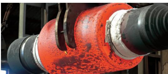
Tras el enfriamiento y solidificación del material en los moldes, según su calidad, es necesario someter a los cilindros a diferentes tratamientos térmicos.
