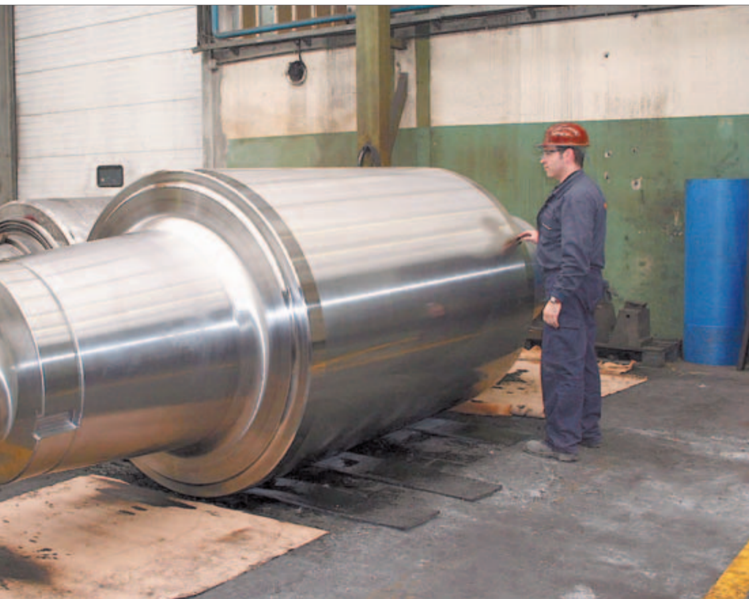
FASE DE MECANIZADO En esta etapa se procede al torneado, fresado y rectificación de la superficie de los tubos. Se realizan ensayos físicos y químicos, exigidos por los laboratorios de calidad.
