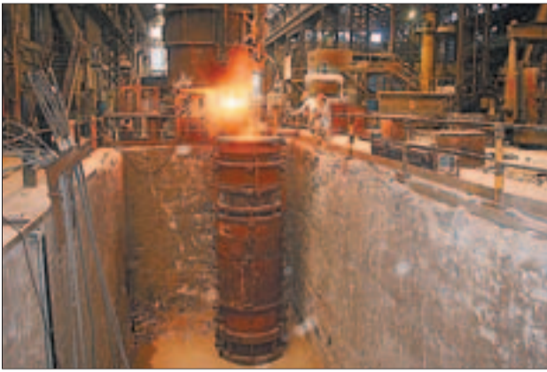
COLADA Y MOLDEO Trabajadores realizan el proceso de colada estática, introducción del metal en el molde. La operación se confía a una máquina controlada automáticamente.
