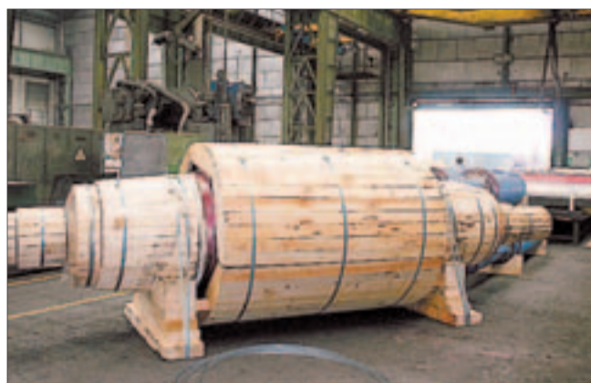
INSPECCIÓN Y EXPEDICIÓN Los cilindros, ya terminados y verificados, son embalados para emprender viaje a su destino. El embalaje se hace según las especificaciones dictadas por cada cliente.
