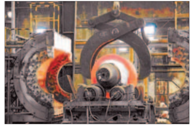
TRATAMIENTO TÉRMICO Tras el enfriamiento y solidificación del material en los moldes, según su calidad, es necesario someter los cilindros a diferentes tratamientos térmicos.
