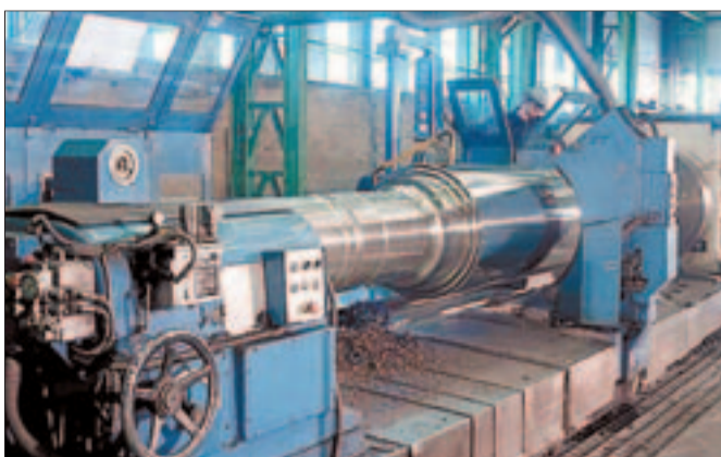
FASE DE MECANIZADO En esta etapa se procede al torneado, fresado y rectificación de la superficie de los tubos. Se realizan ensayos físicos y químicos, exigidos por los laboratorios de calidad.
