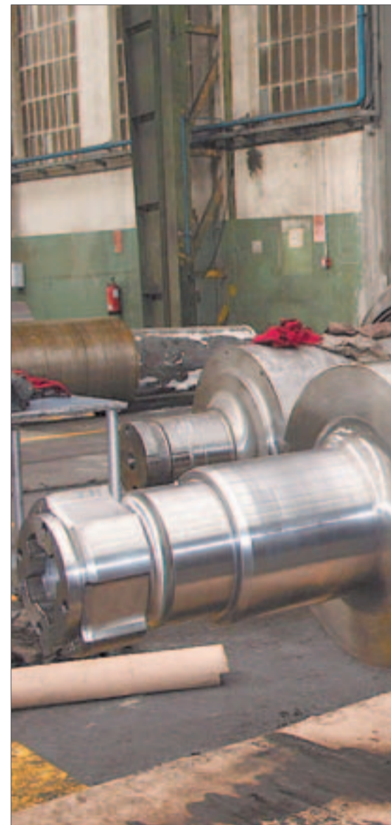
TRATAMIENTO TÉRMICO Tras el enfriamiento y solidificación del material en los moldes, según su calidad, es necesario someter los cilindros a diferentes tratamientos térmicos.
